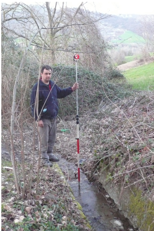
Figura 4.12 Fasi del rilievo strumentale. Con il prisma ottico in prossimità della zona di rilascio .
