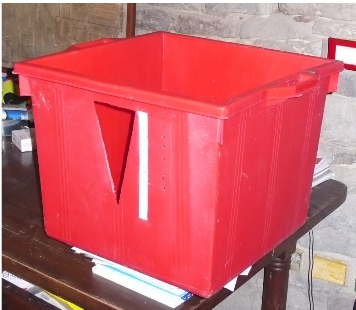
Figura 1.12 Vasca di lettura delle portate con stramazzo triangolare realizzato. La forma cubica ha consentito un facile posizionamento all'interno del manufatto di contenimento del torrente.
