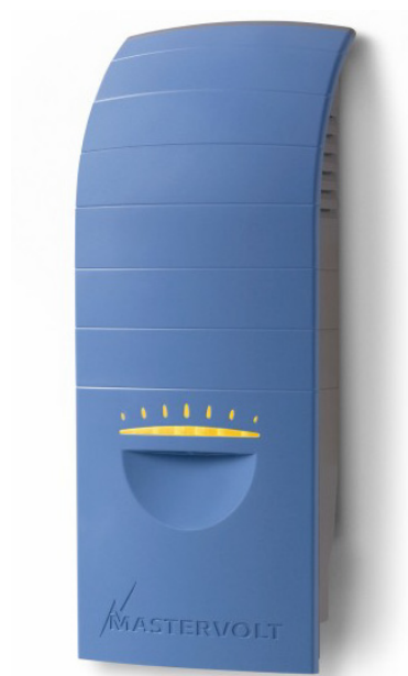
Figura 1.16 Inverter di rete Grid Connected Windmaster500, trasforma la corrente continua dell'alternatore in corrente alternata a 230V, frequenza 50 Hz, sinusoidale pura. La potenza di questo modello è di 525 watt ed un costo di poco superiore ai 400 euro ( Ebay ).
