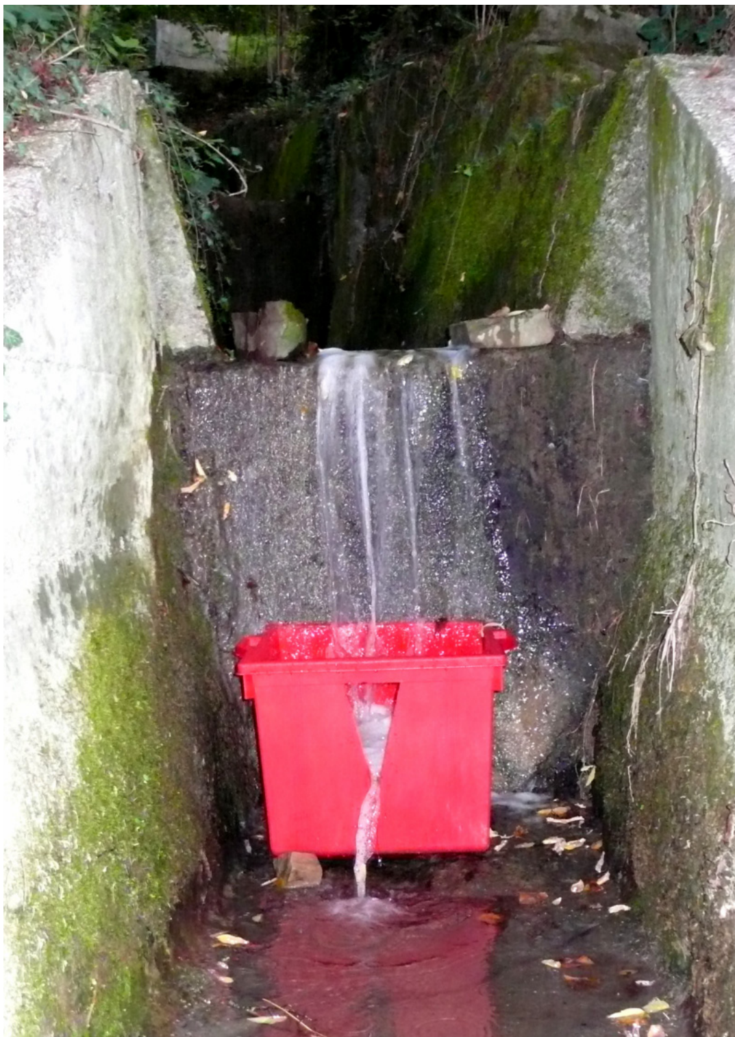
Figura 1.14 Vasca di lettura posizionata all'interno del torrente. Grazie alla particolare conformazione è stato sufficiente deviare la corrente con alcune pietre perché tutta l'acqua cadesse all'interno della vasca consentendo così una misura precisa della portata del torrente
