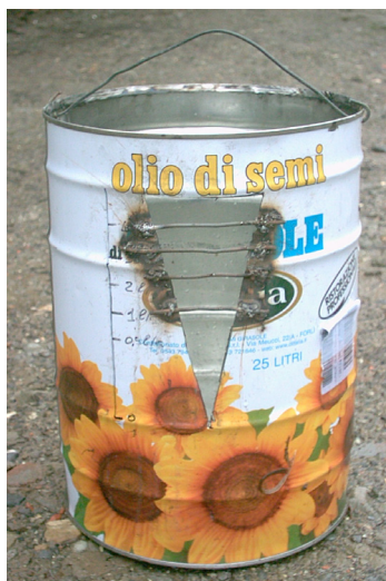
Figura 1.11 Primo prototipo di vasca di misura con idrometro
